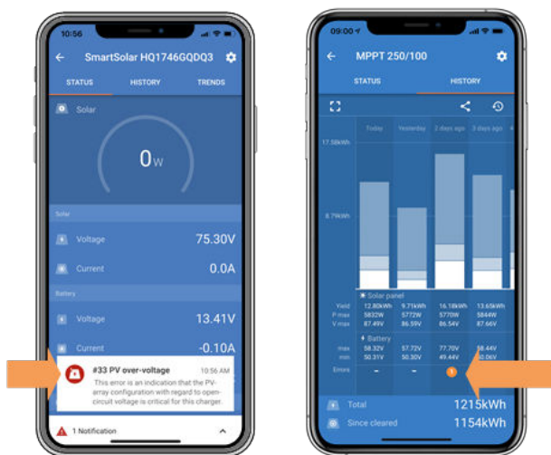
VictronConnect: Screenshot eines #33-Fehlers und Screenshot der Historie, die einen Fehler anzeigt
